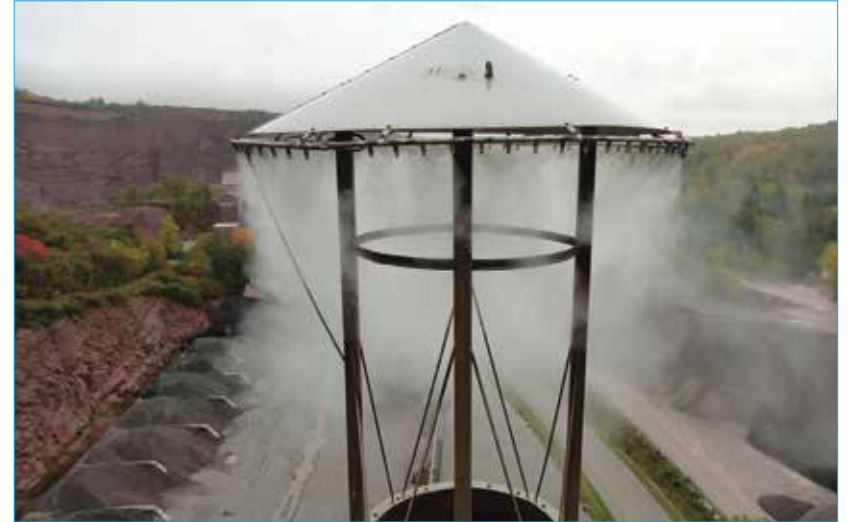
Dit product wordt succesvol toegepast in industriële schoorsteenpijpen om zowel stofdeeltjes als stank te onderdrukken - Maalbersweiler, Duitsland.
