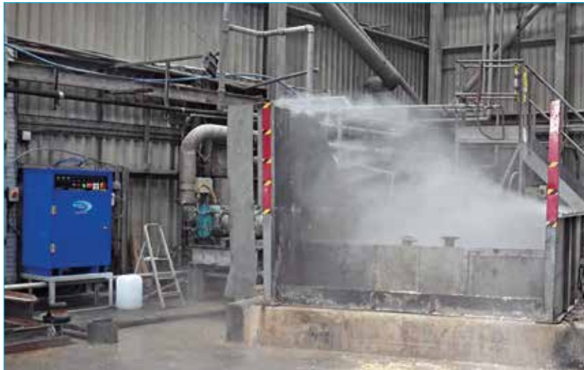
Nevel voorkomt dat stank en stof ontsnappen uit een chemicaliën-mengput - Andigestion, Devon, UK
