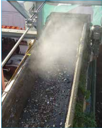
Stort hal - Verneveling bestrijdt verspreiding van stof en stank
